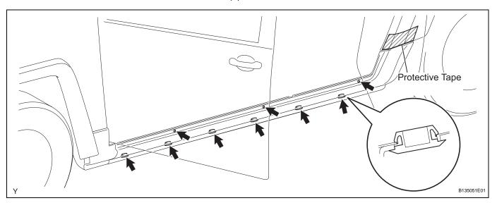
(d) Disengage the 5 clips and remove the rocker panel moulding.
