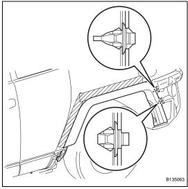
(d) Disengage the 2 clips and remove the quarter outside moulding.
