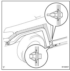
(d) Disengage the 2 clips and remove the front fender moulding.
